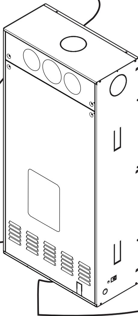
L'unità da incasso permette di installare la caldaia all'interno di una parete/muro esterno all'abitazione.
